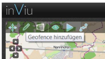
Nach dem Klick auf das Icon „Geofences hinzufügen“ wird der Landkartenmodus außer Kraft gesetzt und es können auf der Landkarte mit gedrückter linker Maustaste die Eckpunkte von Geofences erstellt werden. Man schließt den Kreis und beendet die Erstellung mit einem Doppelklick.
