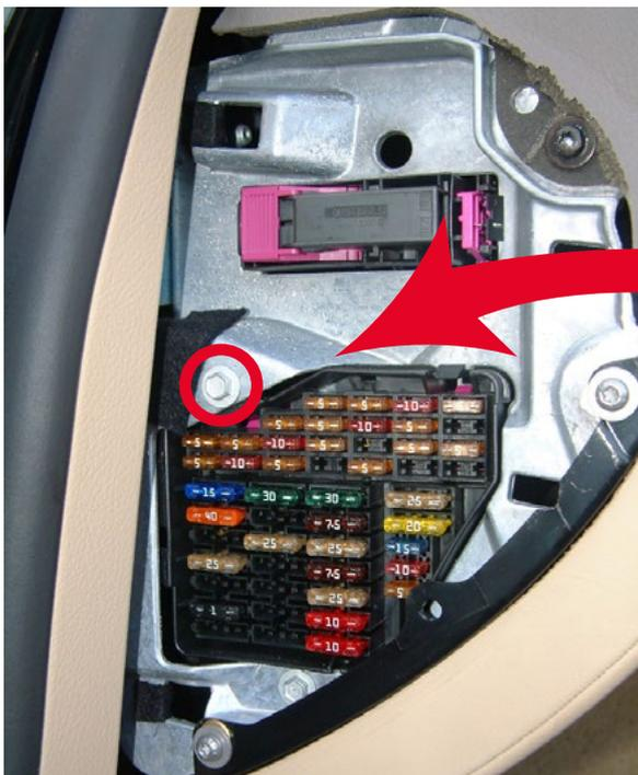
ENAIKOON locate-19 einfach zur Energieversorgung an den Sicherungskasten anschließen: die Ringöse an den Massepunkt schrauben und den Sicherungsadapter an eine passende Sicherung Ihrer Wahl stecken und schon kann es losgehen.
